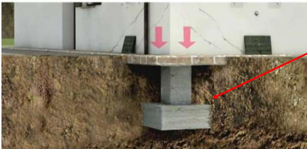
Foto: cimentación expuesta por hundimiento de suelos
